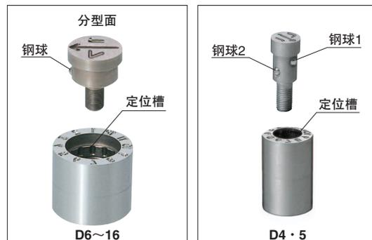
① 因为D4、D5的分度设定为12等分，所以采用了2个偏位钢球加6个槽的定位结构。
