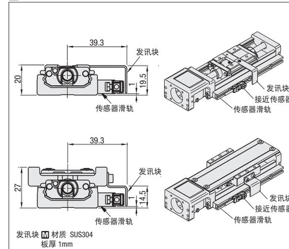
■光传感器型安装图 SUNX制造/OMRON制造
