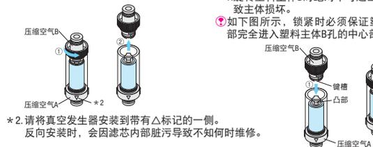
\*2. 请将真空发生器安装到带有△标记的一侧。反向安装时，会因滤芯内部脏污导致不知何时维修。
