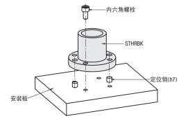
将定位销压入固定板一侧, 进行支座定位后, 利用螺栓
