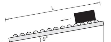
推荐将小型滚轮垫设置在金属板上使用。
