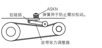
■ 特长: 可用市售的内六角螺栓, 经压入结合后使用。可任意选定螺纹长度。
