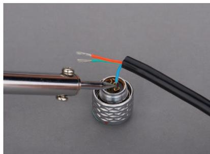
**步骤2** 进行焊接前，将电线穿过连接器各部分，如下图。
