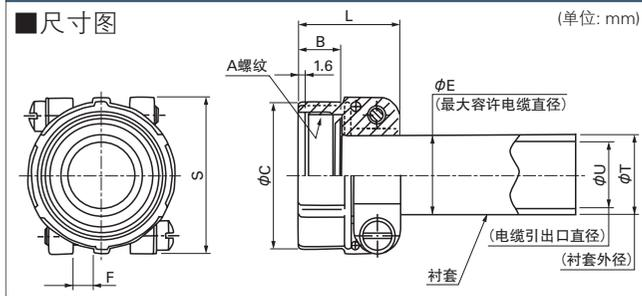
(注1) 请根据连接器的外壳尺寸选择电缆夹。
