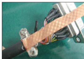
2. 将铜箔反方向折叠
