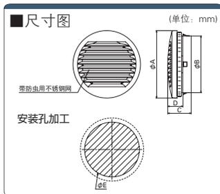
圆型滤网/通风板安装方法
