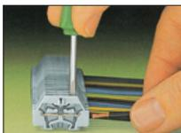
用一字螺丝刀从上部顶入,使内部弹片向下弯曲后,从侧面插入电线。
