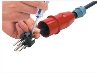
5、用螺丝刀将绝缘部分固定在外壳上
