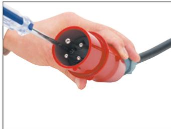
6、加上密封盖，并固定电缆固定头，这样就完成了接线。
