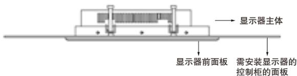
②通过附件中的挂钩螺钉组件将显示器紧固到面板上。
