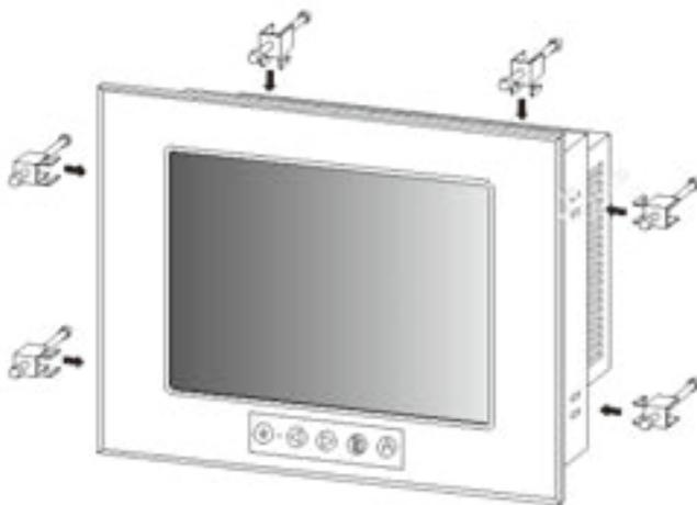
\*FADP-121产品附件中有6个挂钩螺钉组件，FADP-084，FADP-104产品附件中有4个挂钩螺钉组件。
