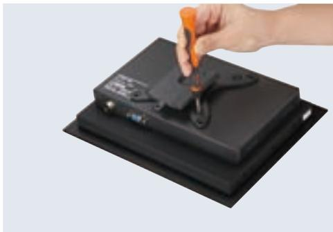
\* MISUMI提供的液晶显示器产品背部VESA孔的最大可旋入深度为6mm。旋入螺钉之前请务必先确认螺钉的长度,以免旋入过深伤及显示器的基板。
