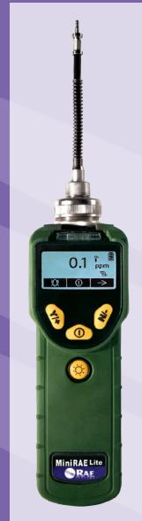
MiniRAE Lite 是一款简化的广谱手持式挥发性有机化合物 (VOC) 气体检测仪，采用华瑞最新的第三代光离子化检测器 (PID)，检测范围达到 0.1~5000ppm。可广泛应用于石油石化、工业安全、环保、应急救援、钢铁等行业。
